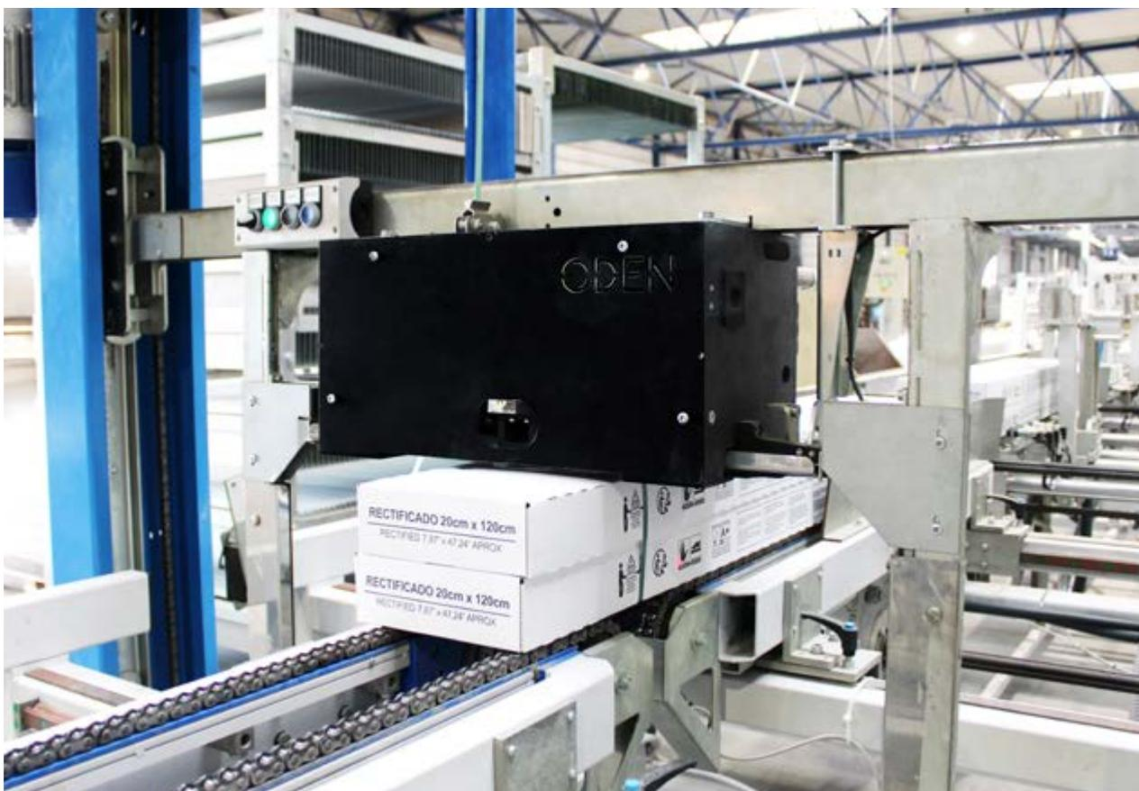
Se trata de un cabezal de alto rendimiento, con menor número de piezas y con electrónica más avanzada para ofrecer mayor control. En el caso de colisión en el lanzamiento, el fleje puede retroceder y repetir la maniobra.
